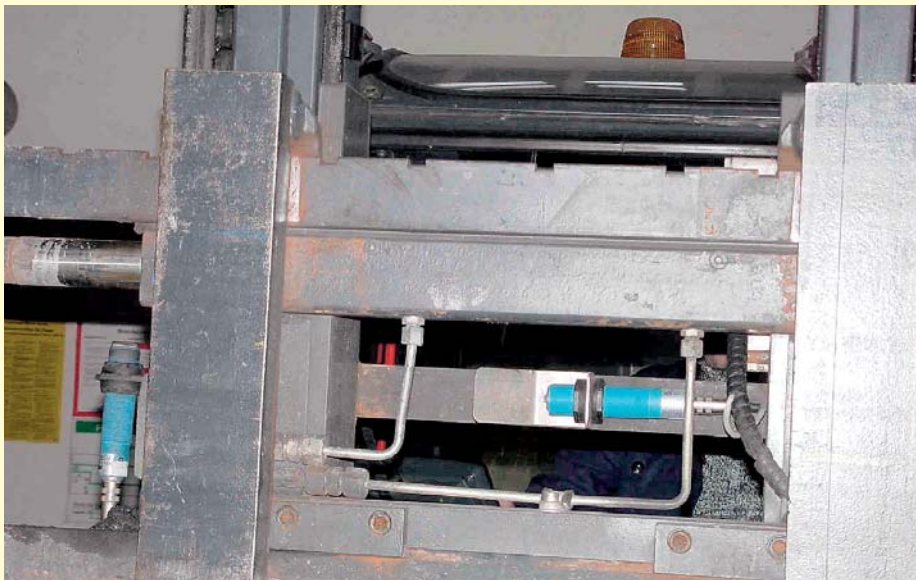
4 Sensoren zur Höhen- und Beladungskontrolle am Schubmast ermitteln die exakte Position des Lastaufnahmemittels
