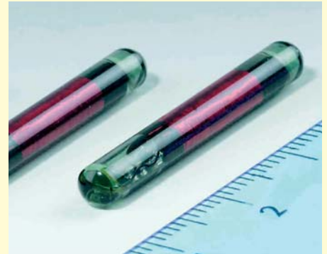
2 Mit Glasröhrentranspondern werden vorab festgelegte Stellen im Hallenboden markiert
