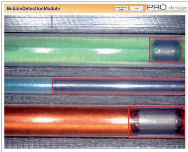
Bubble-Detection Software-Oberfläche mit erkannten Luftblasen in allen 3 Schläuchen
