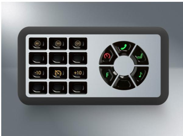
**Im Beispiel der Tempomat-Funktion „Cruise Control“ wechselt das komplette Tastenarray in den Tempomat-Modus. Tasten ohne Funktion bleiben neutral, d.h. es wird kein Icon angezeigt.**
