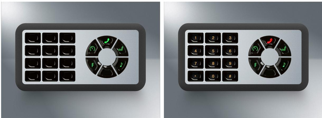
**Im Ausgangszustand bleibt das Tastenarray neutral schwarz. Nach Auswahl der Funktion „Telephone“ werden die entsprechenden Icons einer kompletten Telefontastatur angezeigt, so dass jetzt eine Telefonnummer auf gewohnte Weise per Tastendruck gewählt werden kann.**
