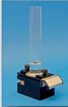
Praktisches Design durch austauschbare Säulenhalter-Einschübe: Bereiten Sie eine Säule vor, während in einer zweiten gemessen wird.
